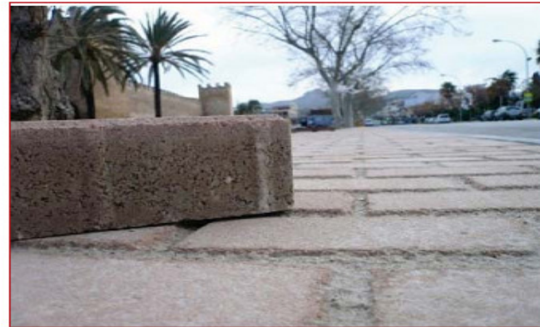
Figura 8.5. Adoquín fabricado a partir de árido reciclado por la empresa Pastor, S.A.
