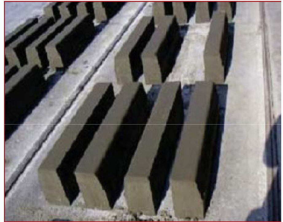
Figura 8.3. Bordillos fabricados a partir de áridos reciclados.
