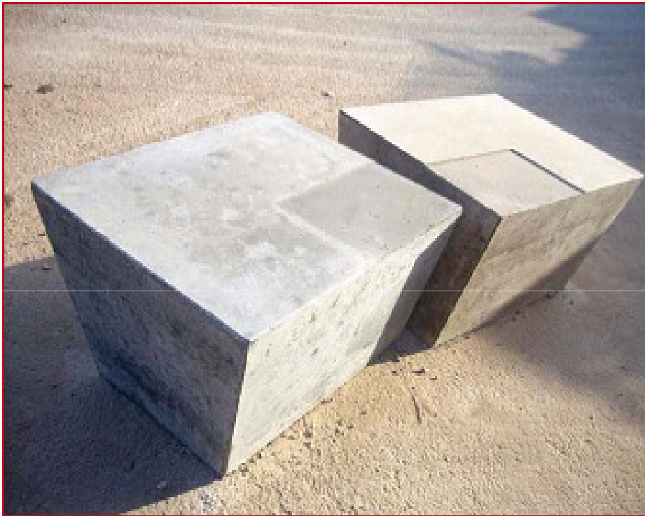
Figura 8.4. Banco de hormigón fabricado con áridos reciclados.
