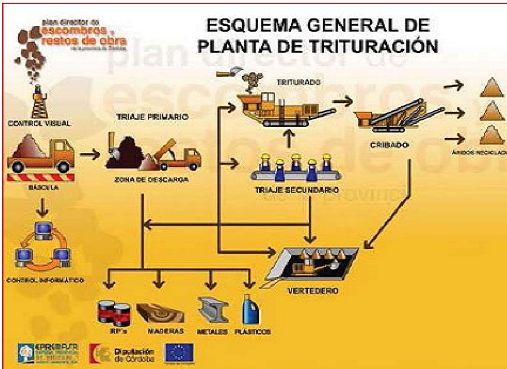
Figura 7.1. Esquema de la planta de tratamiento de RCD adoptada.
