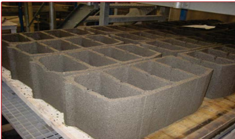
Figura 8.8. Bovedilla fabricada con áridos reciclados con un contenido mayoritario de residuos de hormigón.
