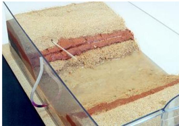
*Las arenas y arcillas simulan capas alternantes de materiales permeables e impermeables. En este caso, un río encajado en su valle fluvial. Las arenas superiores se comportan como acuíferos libres, y drenan sobre las arcillas intermedias dando lugar a fuentes de ladera.*
