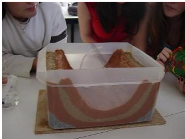
*Modelo de cuenca artesiana. Sinclinal elaborado por alumnos. Si se alimenta con agua la zona lateral en la que afloran las capas de arenas permeables, y posteriormente en la zona deprimida (eje del sinclinal) se perfora desde la superficie hasta dichas arenas intermedias, el agua sube espontáneamente por encima de la superficie (pozo artesiano).*
