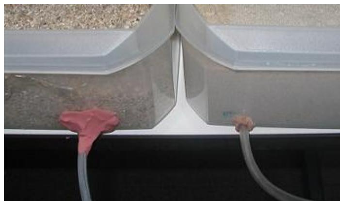
*Detalle de las perforaciones laterales que funcionan como pozos, y permiten visualizar la altura del nivel freático y desaguar los modelos tras su uso.*
