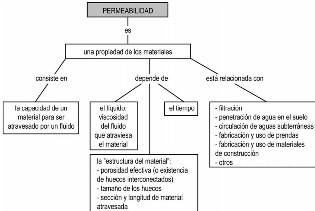
Figura 1.- Esquema conceptual del modelo de permeabilidad.
